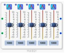
Figure 27. Five-Band Stereo EQ Cell
