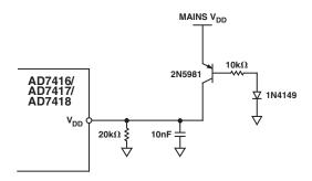
Figure 1. Power-On Reset Circuit
