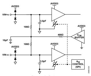
Figure 32. Analog Inputs
