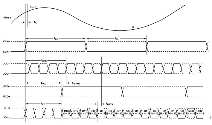
Figure 2. Word Wise DDR, 1× Frame, 14-Bit Output Mode (Default)
