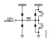
Figure 31. Equivalent LNA Output Circuit
