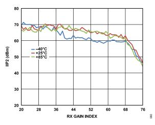
Figure 57. IIP2 vs. RX Gain Index, f1 = 70 MHz, f2 = 71 MHz
