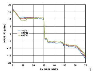
Figure 56. IIP3 vs. RX Gain Index, f1 = 50 MHz, f2 = 101 MHz
