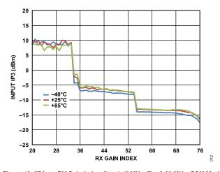
Figure 12. IIP3 vs. RX Gain Index, f1 = 1.45 MHz, f2 = 2.89 MHz, GSM Mode
