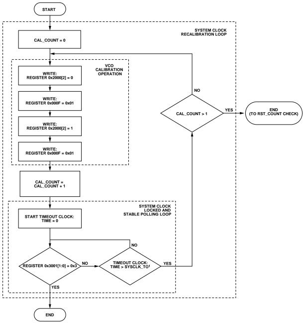
1SYSCLK\_TO IS A CALCULATED TIMEOUT VALUE. IT IS 50ms + SYSTEM CLOCK VALIDATION TIME (REGISTER 0x0207 TO REGISTER 0x0209 [UNITS OF ms])
