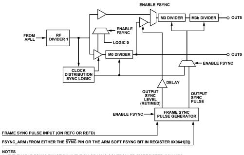
1. THE ENABLE FSYNC FUNCTION IN THE DIAGRAM IS CONTROLLED BY REGISTER 0X0640[0].
