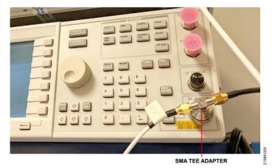
Figure 25. SMA Tee Adapter
