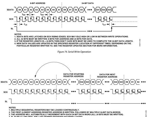
4. SL IS HELD LOW UNTIL THE LAST DESIRED REGISTER HAS BEEN LOADED.
