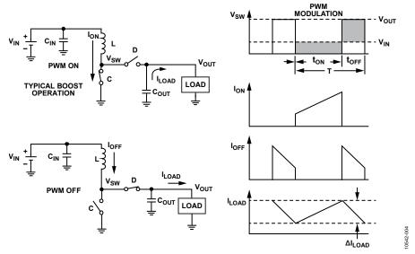
Figure 4. Boost Mode When V<sub>IN</sub> < V<sub>OUT</sub>
