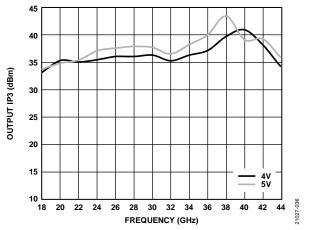
Figure 35. Output IP3 vs. Frequency for Various  $V_{\rm DD}$ ,  $P_{\rm OUT}$  per Tone = 16 dBm,  $I_{\rm DQ}$  = 800 mA
