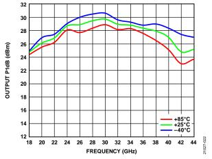
Figure 22. Output P1dB vs. Frequency for Various Temperatures,  $V_{\rm DD} = 5 \, V$ ,  $I_{\rm DQ} = 800 \, \rm mA$
