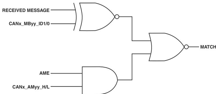
Figure 19-9. Bitwise Acceptance Mask Logic
