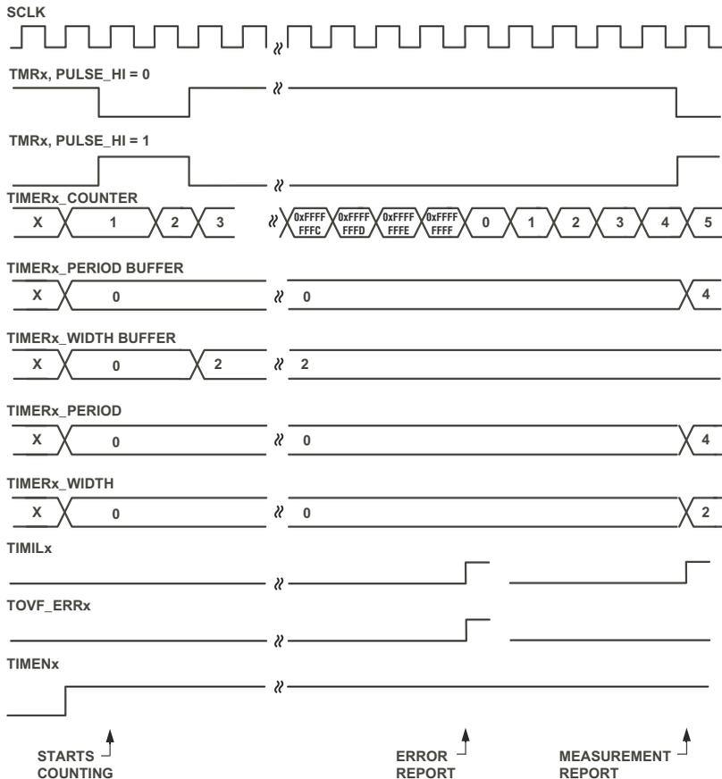
NOTE: FOR SIMPLICITY, THE SYNCHRONIZATION DELAY BETWEEN TMRx EDGES AND BUFFER REGISTER UPDATES IS NOT SHOWN.
