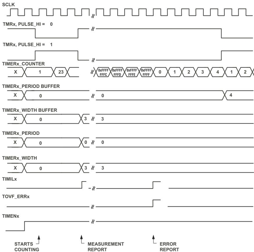
NOTE: FOR SIMPLICITY, THE SYNCHRONIZATION DELAY BETWEEN TMRx EDGES AND BUFFER REGISTER UPDATES IS NOT SHOWN.
