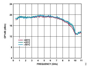
Figure 42. OP1dB vs. Frequency for Various Temperatures,  $V_{\rm DD}$  = 5 V,  $I_{\rm DQ}$  = 60 mA
