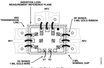
Figure 24. Die Assembly Diagram
