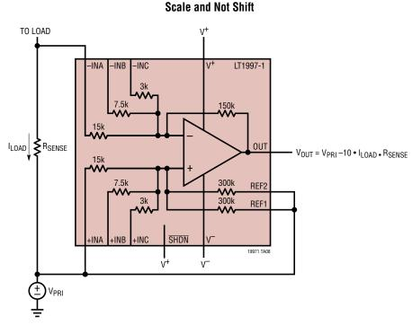
THIS CONFIGURATION SCALES THE INPUT. THE OUTPUT SIGNAL IS REFERENCED TO THE SAME GROUND DOMAIN AS THE INPUT. THUS THE CIRCUIT CAN OPERATE AS A LOW SIDE CURRENT SENSE IN THE PRIMARY DOMAIN. RELATIVE TO THE INPUT GROUND DOMAIN, THE OUTPUT CAN BE TRULY DRIVEN TO "ZERO".
