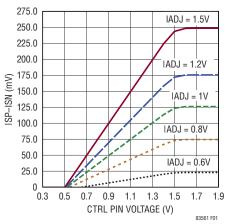
Figure 1.  $V_{\text{ISP}}\text{--}V_{\text{ISN}}$  vs CTRL and  $V_{\text{IADJ}}$  Pin Voltage
