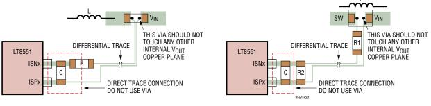
a) Resistor Sensing
