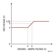
Figure 11. REG Voltage vs REGSNS Voltage
