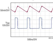
FRONT PAGE APPLICATION 24V<sub>IN</sub> TO 5V<sub>OUT</sub> AT 60mA
