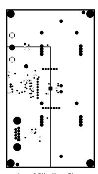
Layer 3 DV<sub>CC</sub> V<sub>BATT</sub> Plane
