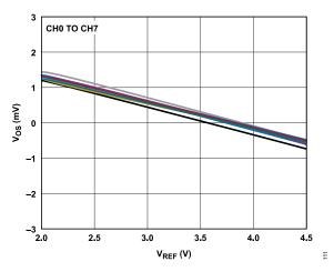
Figure 11. V<sub>OS</sub> vs. V<sub>REF</sub>
