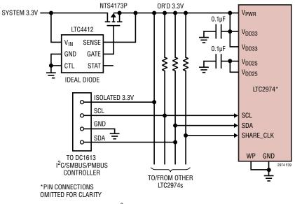
NOTE: DC1613 CONTROLLER I $^2$ C CONNECTIONS ARE OPTO-ISOLATED ISOLATED 3.3V FROM LTC CONTROLLER CAN BE BACK DRIVEN AND WILL ONLY DRAW <10 $\mu$ A ISOLATED 3.3V CURRENT LIMIT IS 100mA
