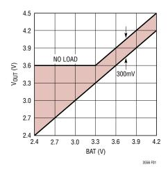
Figure 1. V<sub>OUT</sub> vs BAT
