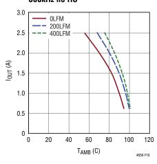
Figure 16. LTM4656 12 $V_{\rm IN}$  36 $V_{\rm OUT}$  650kHz no HS
