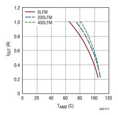
Figure 14. LTM4656 5V<sub>IN</sub> 36V<sub>OUT</sub> 500kHz no HS
