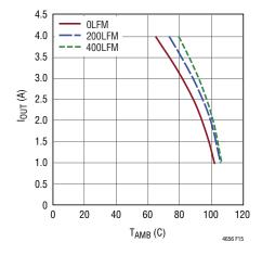
Figure 15. LTM4656 12V $_{\rm IN}$  24V $_{\rm OUT}$  550kHz no HS
