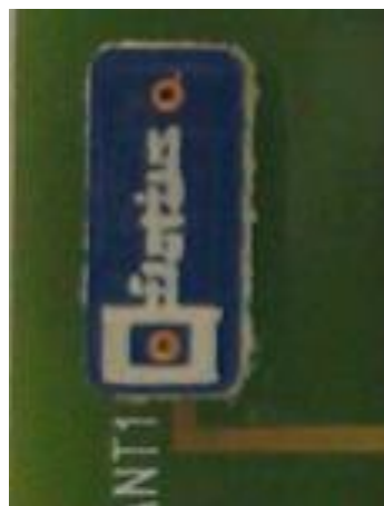
Chip antenna on radio module LTP5901 (Fractus_FR05-S1-N-0-102)
