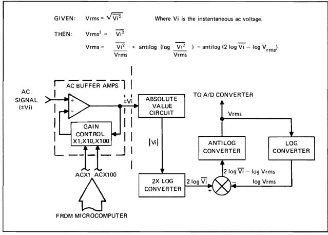
Figure 3-6. RMS Converter
