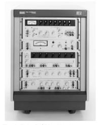
$\textbf{Fig. 1} \ \ \textbf{Fluke 7105A calibration system}$
