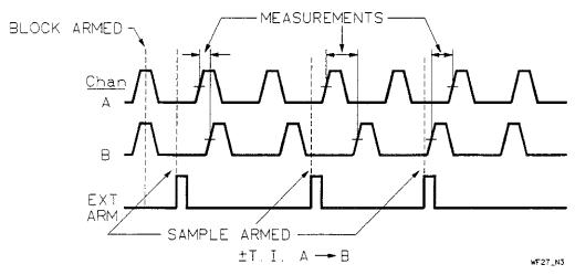
Figure 1-37. ± Time Interval | Repetitive Edge
