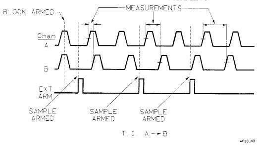
Figure 1-22. Time Interval | Repetitive Edge
