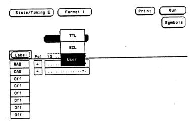
Figure 3-3. Pod Threshold
