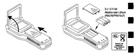
Die Kalibrierung des HP LogicDart wird durch leere Batterien oder den Batterieaustausch nicht beeinträchtigt.
