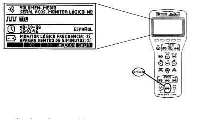
Para utilizar la configuración del sistema, mueva el marcador (texto blanco sobre un fondo negro) hacia la zona de interés y entonces cambie los valores de ese ajuste. En la anterior pantalla, se resalta el ajuste de la familia lógica, TTL.
