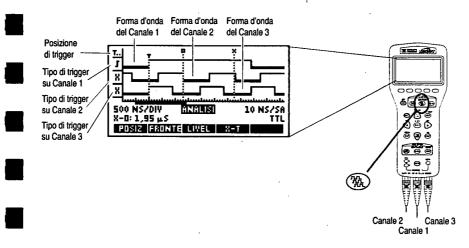
Tali funzioni aumentano il grado di controllo del trigger su forme d'onda e consentono di impostare condizioni di trigger per i tre canali. Premere FAINE o LUNE per scegliere il tipo di trigger, quindi utilizzare uno dei tre tasti menu, CONT, CANE, o CONE per selezionare il canale per il tipo di trigger. Le posizioni e i tipi di trigger sono descritti a pagina 12.
