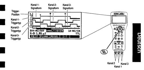
Innerhalb der Betriebsart "Analysieren" haben Sie eine bessere Kontrolle über die Signaltriggerung, da Sie die Triggerbedingungen für alle drei Kanäle einstellen können. Drücken Sie zur Auswahl der Triggertypen FLANK, oder FEGEL, und wählen Sie dann den Kanal für den Triggertyp mit der Menütaste KANAL, KANAL oder KANAL. Triggerposition und Triggertypen werden auf Seite 12 beschrieben.
