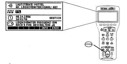
Zum Ändern der Konfiguration bewegen Sie lediglich die Hervorhebung (heller Text auf dunklem Hintergrund) auf das gewünschte Feld, und ändern Sie dann die Werte des betreffenden Feldes. Im vorliegenden Fall ist die Logikfamilie "TTL" hervorgehoben.
