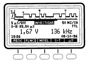
Pulse la tecla de menú que esté debajo de la etiqueta para llevar a cabo la acción. En la anterior pantalla, si pulsa la tecla de menú de la derecha, con la etiqueta  $\Box$ , se enciende o se apaga la medición de  $\Delta V$  (descrita en la página 10).
