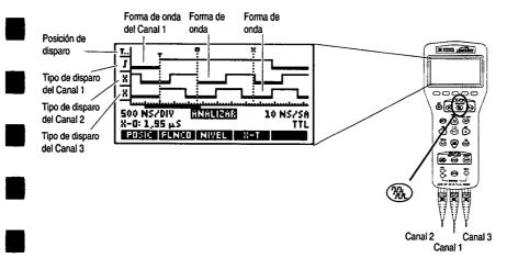
• En Analizar, se obtiene un mayor control sobre el disparo de la forma de onda. Puede establecer las condiciones de disparo para los tres canales. Pulse ELNED o NIVEL para escoger los tipos de disparo y después seleccione el canal para el tipo de disparo mediante una de las teclas de menú EENDA, EGNED o EGNED. La posición de disparo y los tipos de disparo se describen en la página 12.
