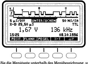
Drücken Sie die Menütaste unterhalb des Menübezeichnung, um die gewünschte Funktion auszuführen. Durch Drücken der rechten Funktionstaste wird die  $\Delta V$ -Messung aktiviert bzw. deaktiviert (siehe Seite 10).
