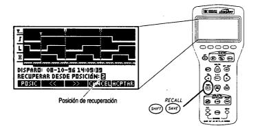
Existen 10 posiciones de almacenamiento de formas de onda, • numeradas del 1 al 10. Pulse and o and para seleccionar una posición de almacenamiento. Cuando la posición deseada esté seleccionada, pulse MCPINE para recuperar la forma de onda y la configuración.
