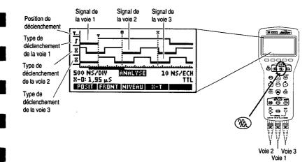
• En mode Analyse, vous disposez d'un plus grand nombre de fonctions pour contrôler le déclenchement, et vous pouvez définir les conditions de déclenchement pour chacune des trois voies. Appuyez sur FRONT ou sur NIVERIO pour sélectionner un type de déclenchement puis sélectionnez la voie concernée à l'aide de l'une des touches de menu WOIEET, WOIEET ou WOIEET. La position du point de déclenchement et les différents types de déclenchement sont décrits en page 12.
