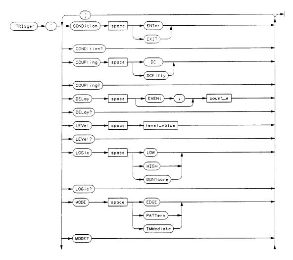
P/O Figure 9-1. TRIGger Subsystem Syntax Diagram
