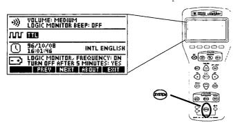
System Setup을 이용하려면 하이라이트(검은 색 바탕에 흰색 문자 표시)를 원하는 위치로 이동시킨 후 그 값을 원하는 값으로 바꿔주면 됩니다. 위의 그림에서는 로직 패밀리 설정치 TTL이 하이라이트되어 있는 것입니다.
