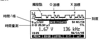
• 使用以下三個步驟來量測時間。首先使用 ◆ 和 ◆ 使 X 游標移至所想要的點上。然後,使用 ◆ 將 ○ 游標移至 X 游標位置。最後,將 X 游標移至下一個所想要的點上,然後讀取顯示幕上的時間。
