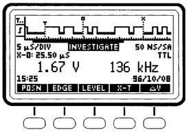
ラベルの動作を実行するには、ラベルの下のメニュー・キーを押します。上のディスプレイでは、右側の とラベルされたメニュー・キーを押すと、 $\Delta V$  測定のオン/オフが切り換わります( $\Delta V$  測定の説明は 10 ページにあります)。
