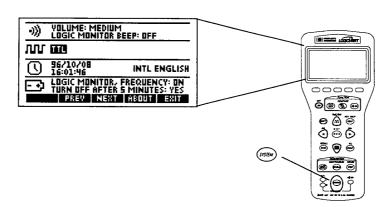
System Setupを使うには、強調表示 (黒地に白のテキスト)を目的の領域に移動し、 設定された値を変更します。Logic Family 設定 TTL が上の画面で強調表示され ています。
