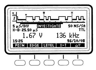
按标号下面的菜单键完成那种动作。在上面的显示器中,按右面菜单键,标号 $\Delta V$ ,接通或断开  $\Delta V$  测量(在第 10 页中叙述)。
