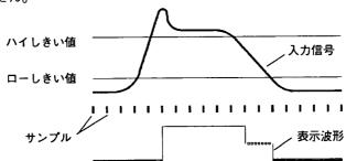
● ハイしきい値の下と、ローしきい値の上には、許容範囲があります。許容範囲内に入る入力信号は、各レベルまたはトライステートのどちらかで表示されます。例えば、入力信号レベルがハイの許容範囲にある場合、波形のロジック・レベルは、ハイ・レベルとトライステート・レベルのどちらかになります。許容範囲の幅は、使用するロジック・ファミリに依存し、35ページの仕様で定義されています。
