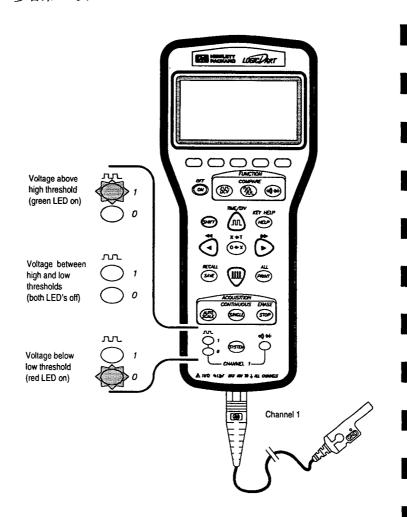
· 逻辑监视器和浏览器一起使用,快速定位活动的或固定的节点,电源供给和接地。第5页表明怎样使用探头。
