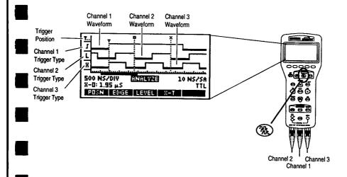
• 在 Analyze(分析)方式下,你在波形触发上有多种控制。你能够 对所有三个通道设定触发条件。
