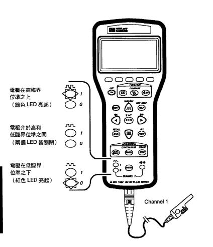
邏輯監視器與瀏覽測試棒搭配使用,可快速地找出電壓有變化 或電壓固定的端點、電源和地端所在之處。第5頁說明如何使 用測試棒。
