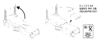
HP LogicDart의 교정 상태는 배터리 방전이나 배터리 교환 등으로 그 내용이 변경되지는 않습니다.
