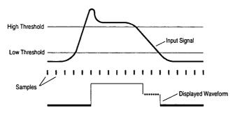
在高门限以下和低门限以上存在有出差带。在出差内的输入信号值能够被显示为一个逻辑电平或一个三态电平。例如,如果输入信号电平处在高出差带内,波形的逻辑电平可能是高电平或者三态电平。出差带的宽度取决于所使用的逻辑系列,在第35页上的技术条件中定义。
