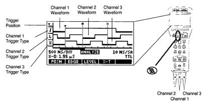
• Analyze에서는 파형의 트리거를 보다 다양하게 바꿔볼 수 있습니다. 세 개 의 채널에 대한 트리거 조건을 모두 다르게 설정할 수도 있습니다. ■2025 나 LEVEL 는 트리거 타입을 선정하고, 다음에 **CH1** 나 **CH2**, **CH3** 등 의 메뉴키를 이용하여 채널을 선택합니다. 트리거 위치와 트리거 타입에 대 해서는 12 페이지에 설명되어 있습니다.
