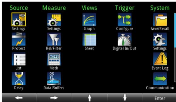
Von diesem Bildschirm aus können Sie folgende Menüs auswählen: „Source“, „Measure“, „Graph“, „Trigger“ und „System Setup“. Mit diesen Menüs können Sie Optionen auswählen und so Ihr Gerät speziell für Ihre Anwendungen konfigurieren. Wählen Sie einen Konfigurationspunkt aus, indem Sie das entsprechende Symbol markieren. Verwenden Sie dazu entweder das Navigationselement oder die Pfeiltasten. Drücken Sie anschließend **ENTER**.
