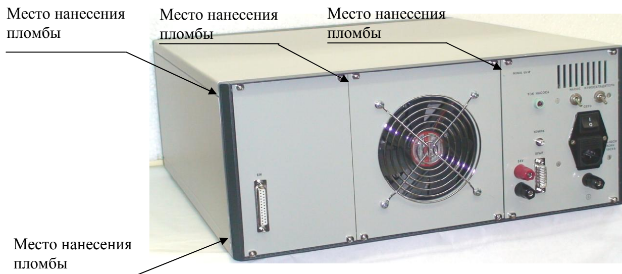
Рисунок 4 – Схема пломбировки от несанкционированного доступа блока криогенного
