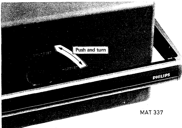
Abb. 2.2. Abnehmen des Frontdeckels
