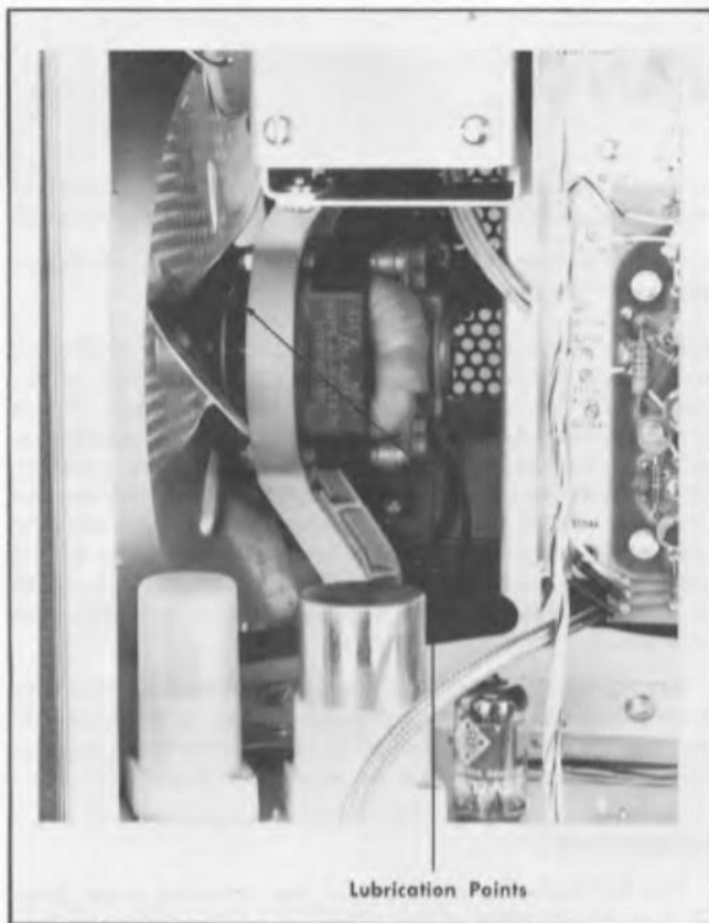
Fig. 4-1. Fan motor lubrication points.
