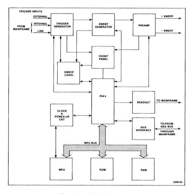
Fig. 5-1. 7B90P Block diagram.
