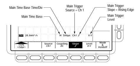
Figure 3–36: Edge Trigger Readouts
