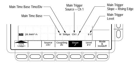
Figure 3-42: Edge Trigger Readouts
