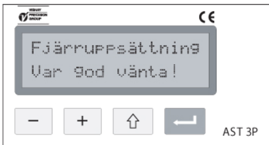
Figur 6. Medan uppsättning från styrenheten pågår visas ett meddelande, och tangenterna kan inte användas.
