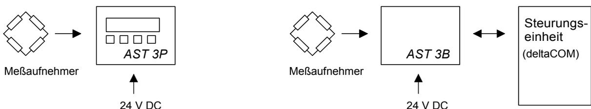
Abbildung 1. Die verschiedenen Ausführungen erfordern eine unterschiedliche Installation für die Parametereinstellung.
