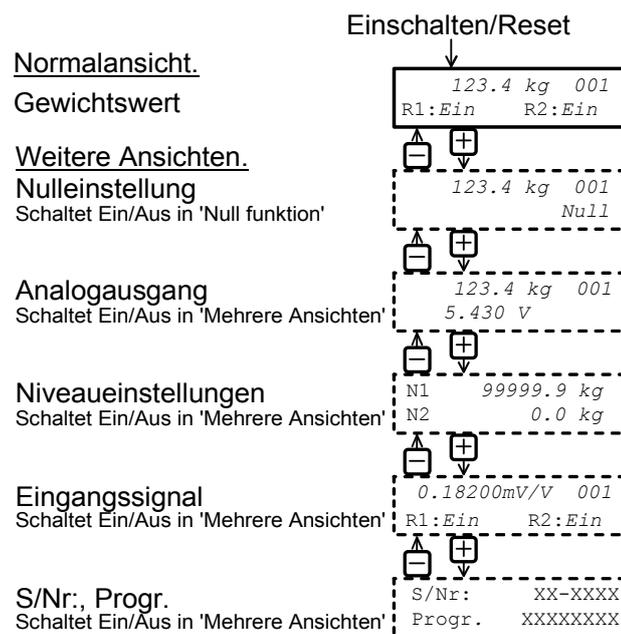
Abbildung 3. Im Betriebsmodus kann der Gewichtswert immer angezeigt werden. Über die Funktionstasten + und - können auch weitere Ansichten ausgewählt werden, vorausgesetzt daß die Ansichte 'Ein'-geschaltet sind.
