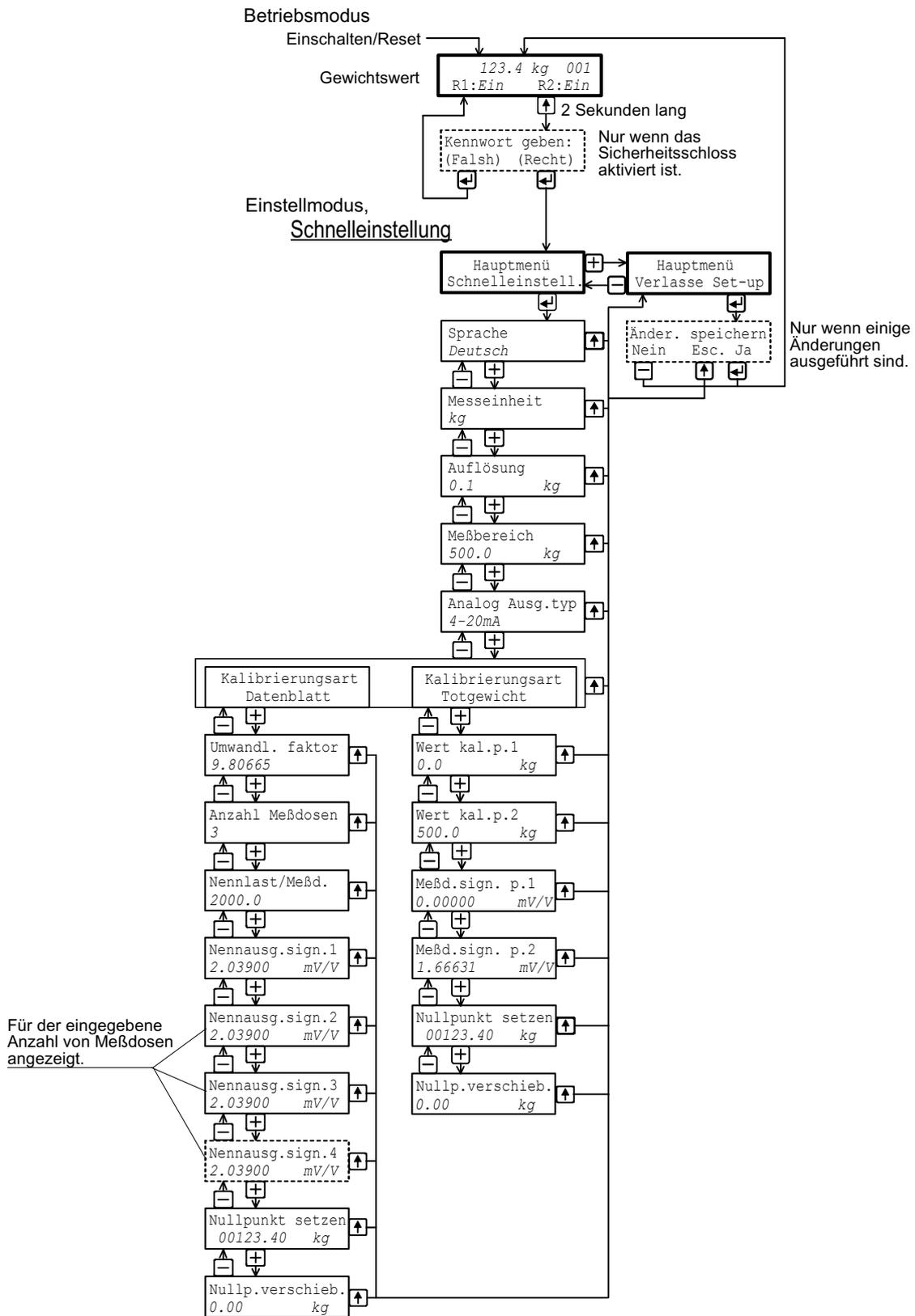
Das Diagramm zeigt die Parameter der 'Schnelleinstellung' und die Verwendung der Funktionstasten zur Anzeige dieser Parameter.
