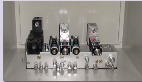
安装于独立控制箱的油压伺服阀
