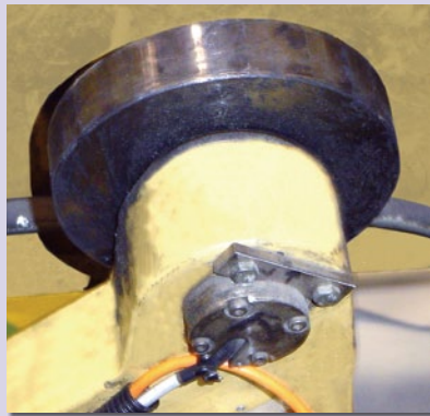
二次臂的传感器直接安装于滚筒轴
