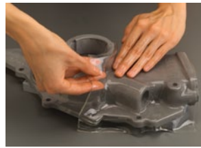
PhotoStress- Beschichtung auf einem komplex geformten Bauteil
