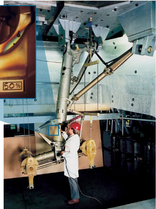
PhotoStress Analyse am Fahrwerk eines Flugzeugs
