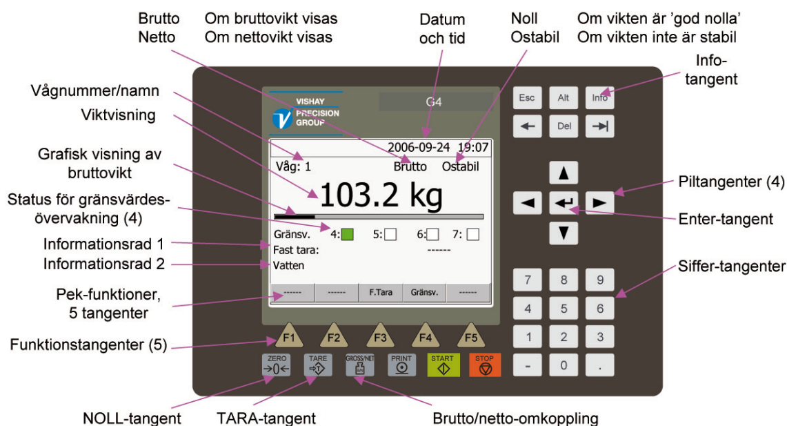
G4, typ PM, DT och HE. Instrumentets frontpanel.
