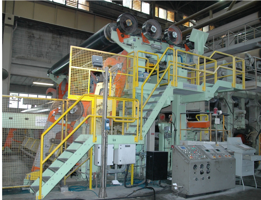
Abbildung 1: Viele Verbesserungen wurden hinzugefügt, um den Aufroller modernen Standards anzupassen und die Eigenschaft zu verbessern eine hochwertige Papierrolle herzustellen.
