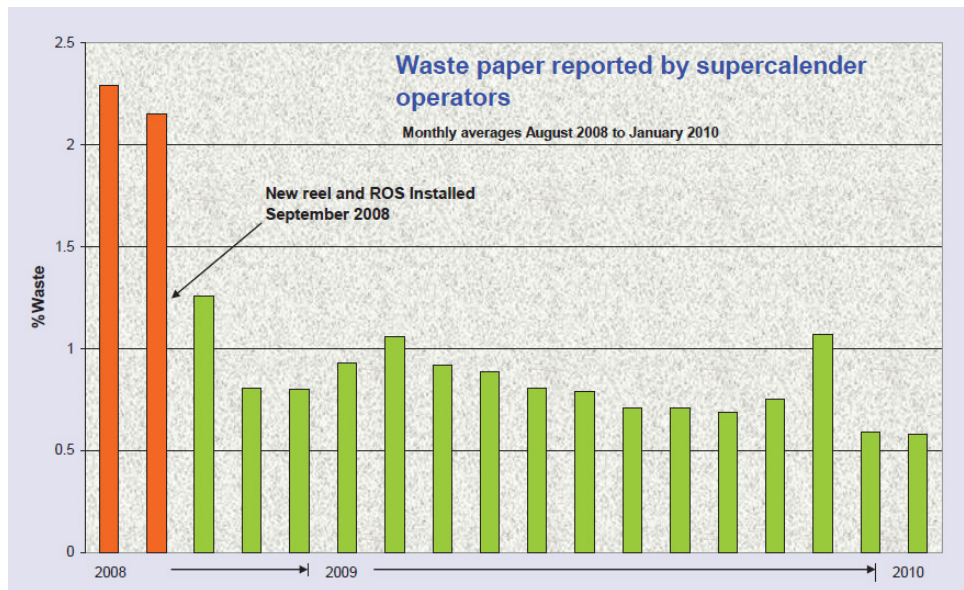
Abbildung 2: Vom Bedienpersonal der Superkalender registrierte Ausschussmenge; monatliche Durchschnittswerte August 2008 bis Januar 2010; Neuer Poperoller und ROS installiert im September 2008
