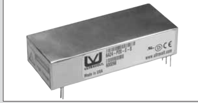
M:ノイズ除去シールド (EMI, RFI, 高圧磁場を低減)
