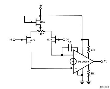
$*V_{\rm OS}$  null (V\_{\rm OS} is typically < 25 mV)  $I_{\rm BIAS}$  < 50 pA
