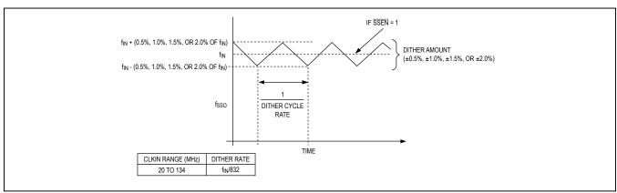
Figure 1. DS1181L Spread-Spectrum Frequency Modulation
