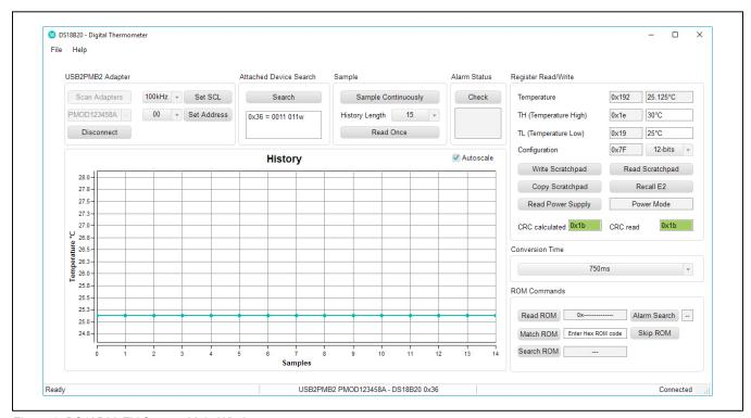
Figure 1. DS18B20 EV System Main Window
