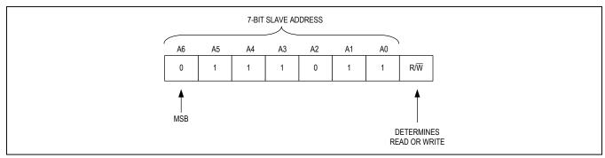
Figure 43. DS2476 I<sup>2</sup>C Slave Address
